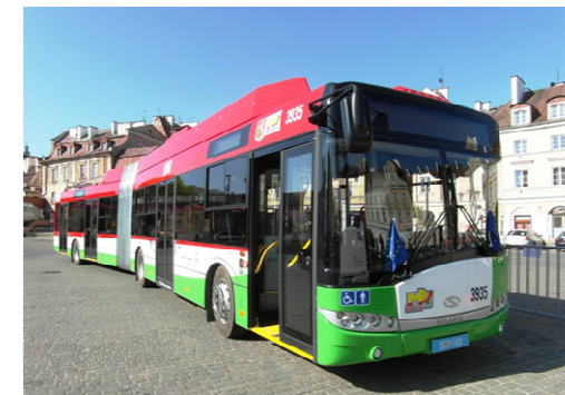
Solaris Trollino 18M z układem jazdy autonomicznej
